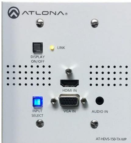
Dessous le meuble rouge, il y a une prise d'alimentation électrique, ainsi qu'une plaque de connexions. Cette plaque de connexions est une des options pour envoyer le signal d'un ordinateur portable au système de projection.
